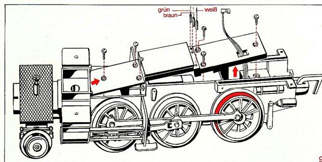
**Bild 9 Fahrgestell-Motorwechsel**
